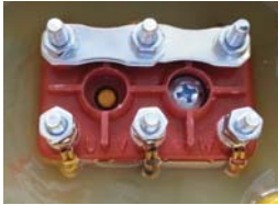
Resim 2: Klemens üzerinde yıldız bağlantı
